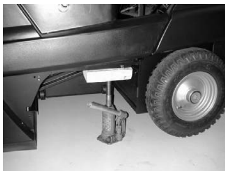
Kocsiemelő felfektetési pontja (hátsó kerekekénél)
