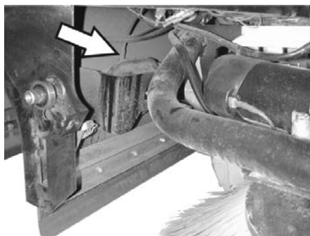
Priključak crijeva za vakuumsku utičnicu dijela za spuštanje bočne metle
