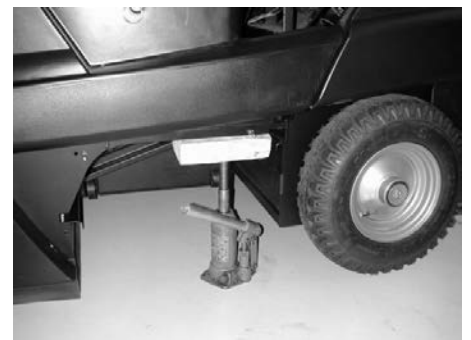
Място за поставяне на автомобилния крик (задни колела)
