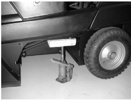
Точка установки домкрата (задние колеса)
