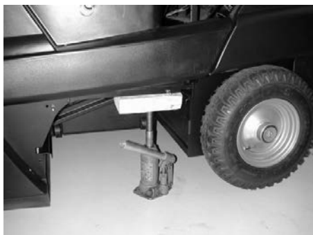
Bod uchytenia pre zdvihák vozidla (zadné koleso)
