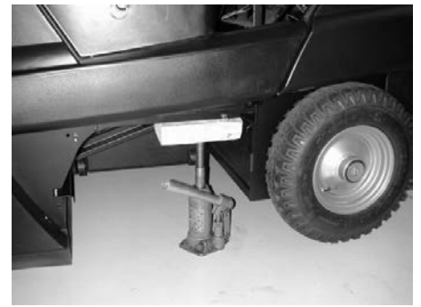
Aufnahmepunkt für Wagenheber (Hinterräder)
