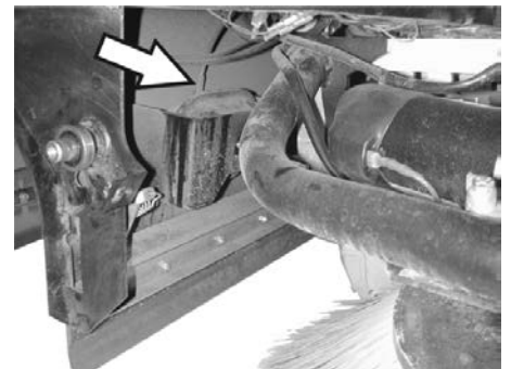
Schlauchanschluss zur Unterdruckdose der Seitenbesenabsenkung
